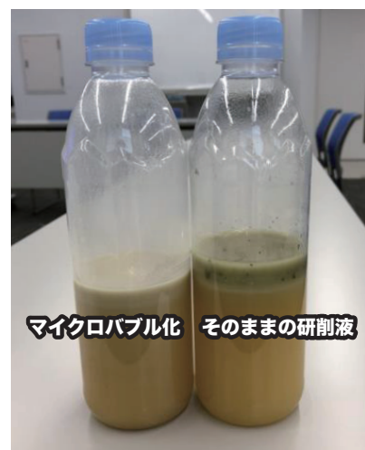
研削液をボトルに入れてしばらく放置した状態。 ナノバブル化した研削液は乳化の持続と腐敗菌の抑制が確認できる。
